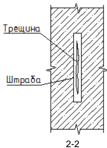
Поз.2. Обустройство штрабы «Ласточкин хвост»
