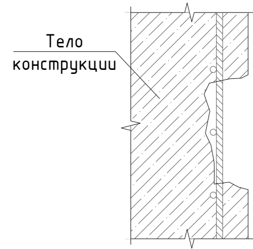
Поз. 1. Участок до производства ремонтных работ
