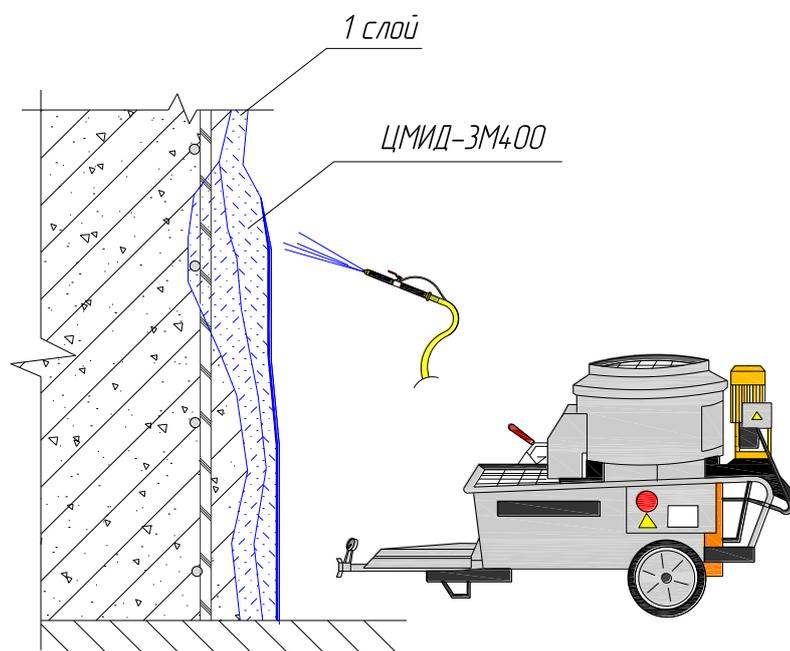
Поз. 2. Нанесение состава ЦМИД-3М400
