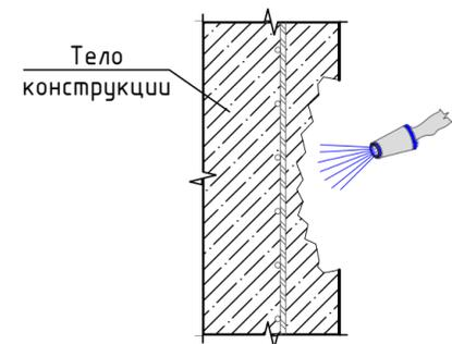
Поз. 5. Нанесение ремонтного состава ЦМИД-ЗПМ
