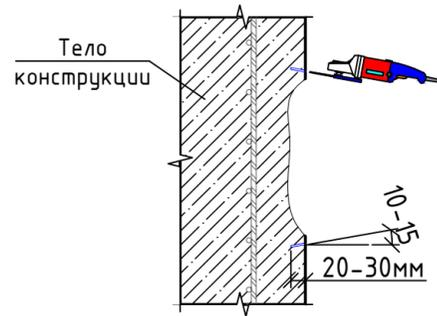
Поз. 3. Демонтаж деструктивного бетона
