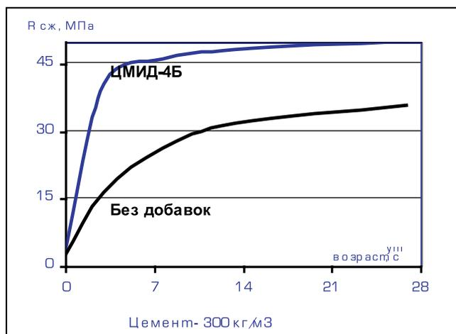
Укладка бетонных смесей с добавкой **ЦМИД-4Б** может осуществляться как с помощью виброуплотнения, так и без воздействия вибрации, при подаче бетононасосом, по бетонолитной трубе или бадье. Смеси легко перекачиваются и отличаются полным отсутствием водоотделения и расслоения.
